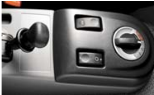
Het bedieningspaneel van de AS-Tronic is praktisch geplaatst naast de chauffeursstoel.
