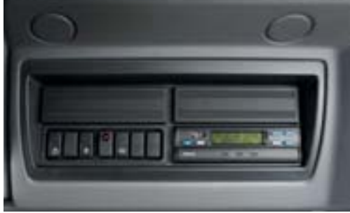
De tachograaf is praktisch geplaatst in de console boven de voorruit.
